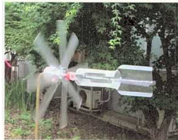
トンボの羽の仕組みを生かした風力発電機
